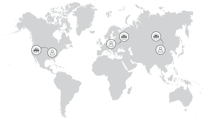
图5 通过在接近终端用户的数据中心之间动态地分配工作负载及其状态，改进网络性能展示
